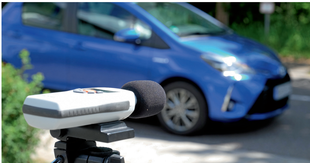
In einem Feldversuch wurde die Geräuschreduzierung durch die Tempodrosselung von 50 auf 30 km/h gemessen.
