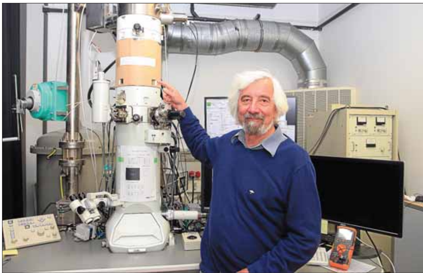
Maximilian Haider zeigt die Position des Korrektors im Elektronenmikroskop. Foto: Hebbelmann
